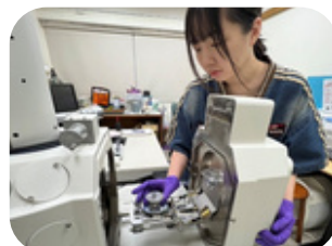
學生在實驗室操作SEM分析材料
