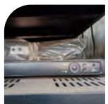
警衛室監視主機
